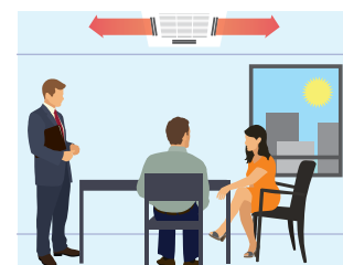
Neřímsé proudění vzduchu při detekci pohybu
